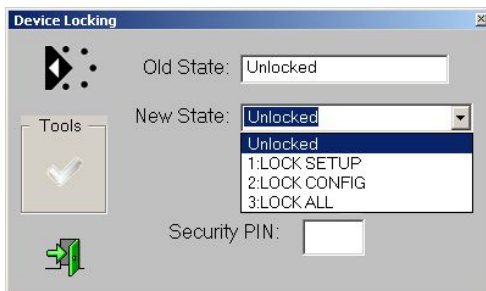
Auswahl des LOCK-Modus beim GET/SET Controller
